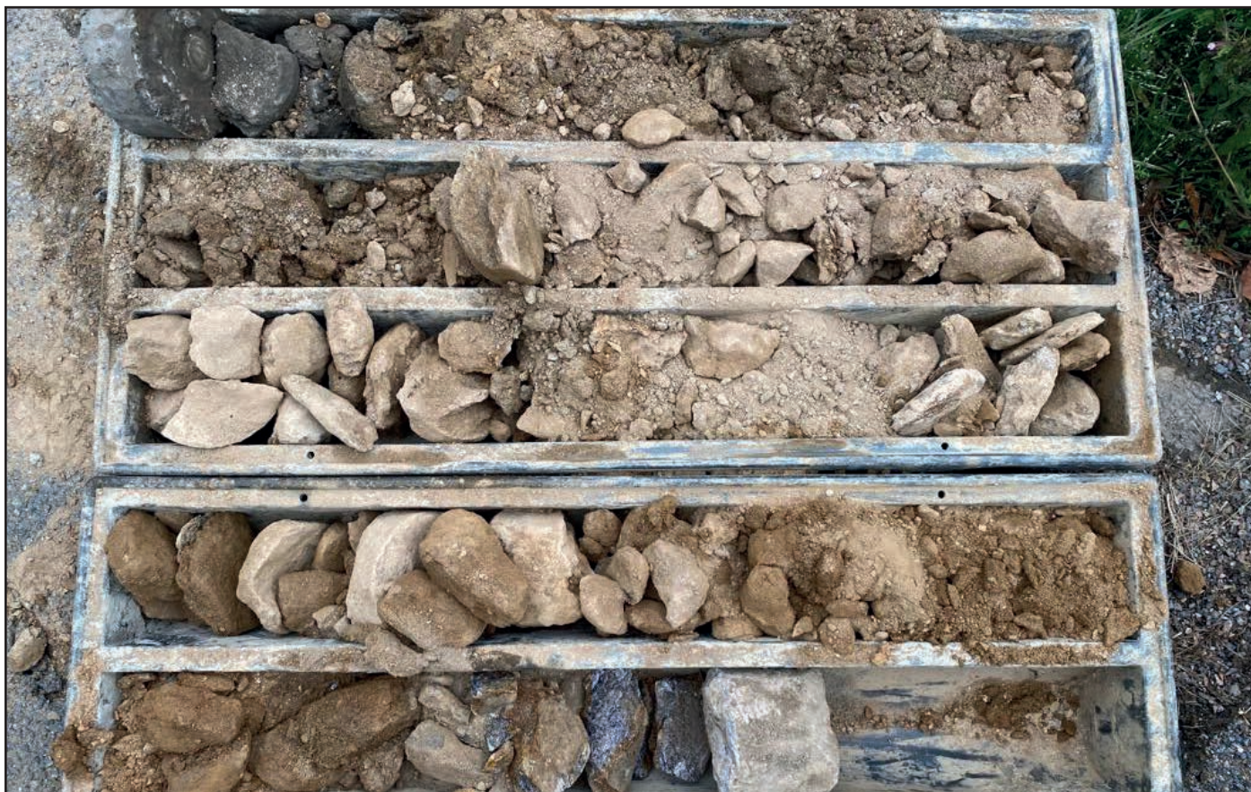
Geologický profil vrtu VS1
